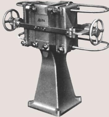
В 1931 году компания Альфа Лаваль представила первые пластинчатые теплообменники для молочной промышленности. Пластины были 5–10 мм толщиной и имели фрезерованную поверхность, тогда как сегодня толщина пластин составляет 0,4 мм. При разработке наших теплообменников мы исходили из соображений экономической эффективности.
